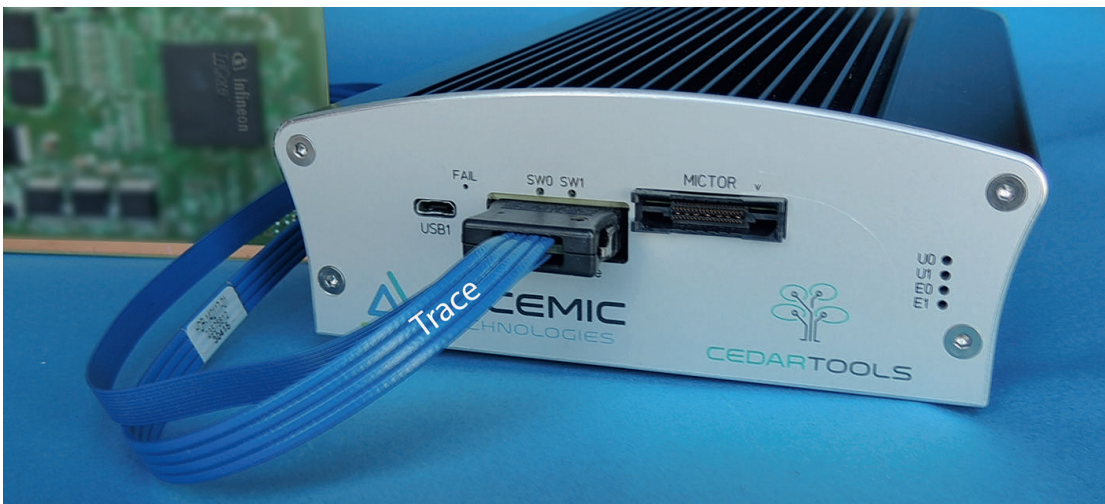
Bild 1: CEDARtools ist ein Werkzeug für die Analyse komplexer eingebetteter Systeme entwickelt, mit dem das Problem der begrenzten Größe der Trace-Buffer gelöst wird. Wichtige OEMs und Tier1 evaluieren und verwenden das System bereits. © Accemic Technologies
